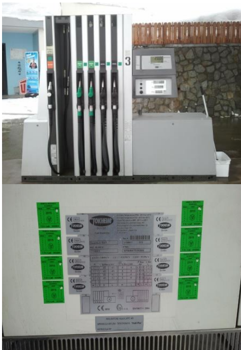
Foto: Eichschild, grüne Fälligkeitskleber, Blick in eine Zapfsäule
