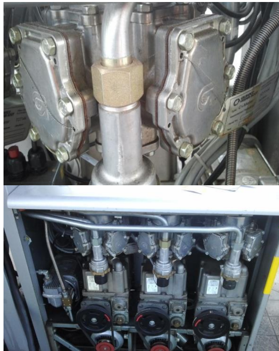
Foto: Eichschild, grüne Fälligkeitskleber, Blick in eine Zapfsäule
